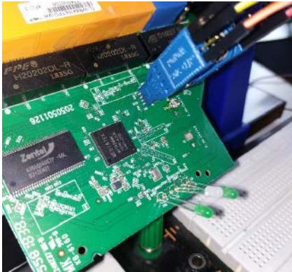
Sind die Kabel den Pins auf dem Raspberry Pi richtig zugeordnet und ist auf dem Flash-Chip Pin 1 identifiziert, muss noch die Messklemme auf den Chip gesetzt werden (Abb. 9).
