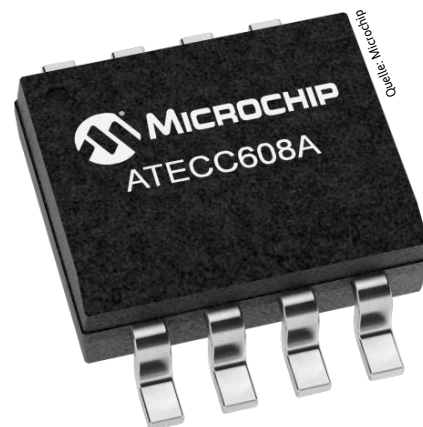
Ein Hardwaresicherheitsmodul besteht aus einem kryptografischen Coprozessor und Speicher für die Schlüssel (Abb. 1).
